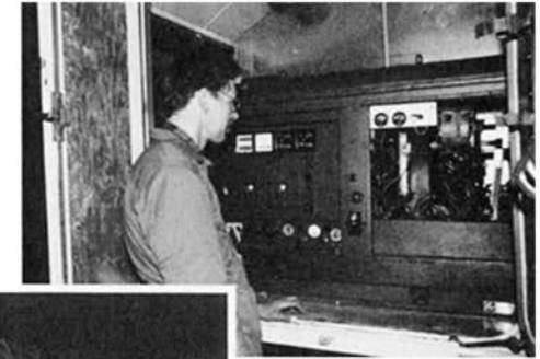
▲ Für die Technik ist Günter Buchholz zuständig. Der Stromerzeuger im Gerätewagen versorgt den Lichtmast.
